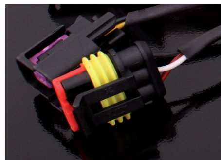
Fig 4.1a - 3-poliga Superseal kontakt. Svart tråd: Signal GND. Vit tråd: AIN4 (0-5V). Röd tråd: +5V från ECU.
